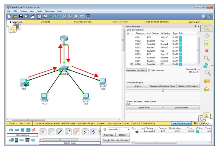
Ici, un ping de PC2 vers PC5 (appartenant respectivement aux VLANs 10 et 20) est fonctionnel. Le routage inter-VLAN fonctionne donc dans notre topologie.
