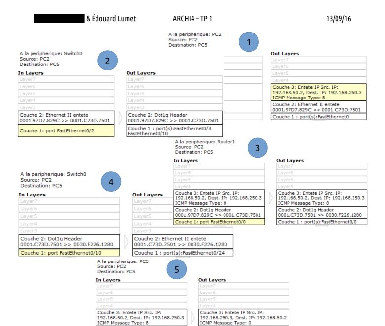
Trame originelle au niveau de PC2 à destination de PC5 (ping PC2 > PC5). Les protocoles sont IPv4 et Ethernet.
