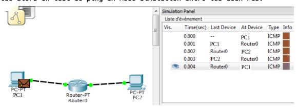
Le test de ping est fonctionnel et on voit que PC1 envoie bien à sa passerelle par défaut (le routeur), ce dernier routant bien le ping vers PC2.
